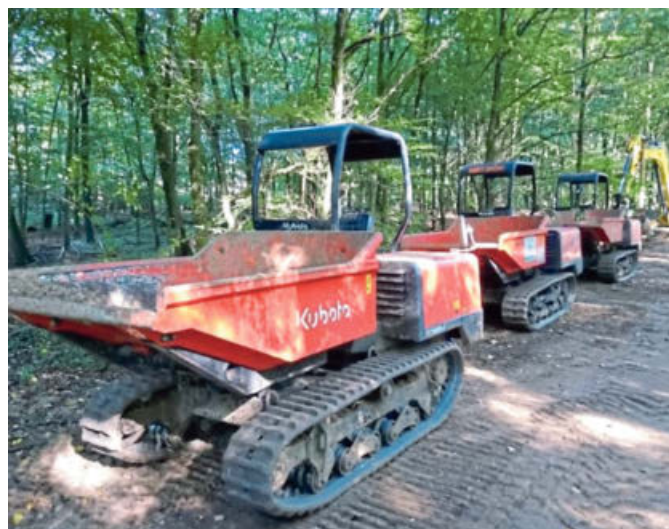
Große Bagger und Lkw würden einen starken Eingriff in die Natur nach sich ziehen. Deshalb kommen diese Vorderkipper – auch Dumper genannt – zum Einsatz.
